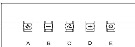
**A: AAN/UIT-toets lamp:** als u op deze toets drukt, gaan de lampen van de kap branden of doven ze.
