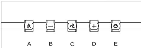
A: AN/AUS - Taste Licht: durch Betätigen der Taste werden die Lampen der Dunstabzugshaube ein- bzw. ausgeschaltet.
