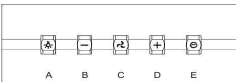
**A: Taster za svetlo UKLJ/ISKLJ (ON/OFF):** nakon dodirivanja tastera gase se svetla nape.
