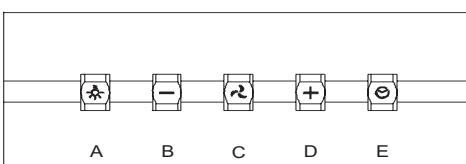
**A:** Tlačítko ON/OFF svetlo: pri dotyku sa zhasnú alebo rozsvietia svetlá digestoru.
