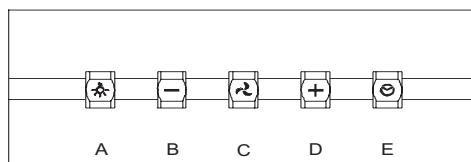
A: Tasta ON/OFF iluminare: la contactul cu tasta se aprind și se sting luminiile hotelui.
