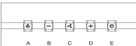
**A: Клавиша ON/OFF свет:** при нажатии клавиши включается или выключается свет вытяжки.
