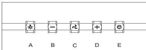
**A:** Tecla ON/OFF da luz: ao contacto da tecla, as luzes da câmara acendem-se ou desligam-se.
