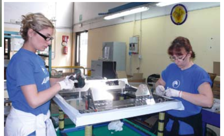
Anspruchsvolle Handarbeit: Montage einer 90 cm breiten Inselhaube.
